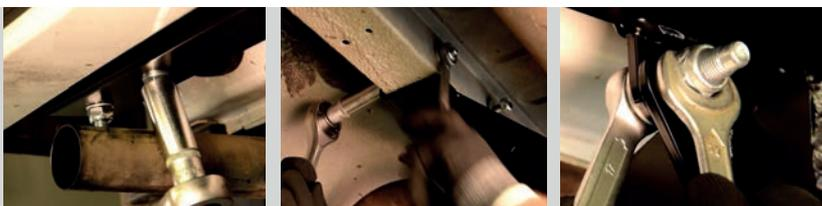
**ШАГ 5.** Установите кронштейн крепления электрической розетки. Установите съемный шар в сборе и закрепите его пальцем гнутым с шплинтом. Зафиксируйте съемный шар винтом M10x20 снизу. Установка завершена.
