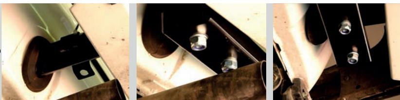
**ШАГ 2.** Для установки центрального кронштейна совместите отверстия кронштейна с отверстиями в ушках поперечной балки и соедините болтами M12x45x1,25 через шайбы M12 и самоконтрящиеся гайки M12x1,25.
