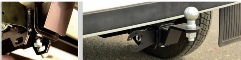
Тип соединения: шаровый; Диаметр сцепного шара: 50 мм.; Масса комплекта ТСУ 01211501: 12 кг.
