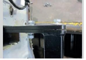
**ШАГ 3.** Закрепите каждую закладную пластину в ближнем отверстии с помощью болта М10х40х1,25 через шайбу гроверную М10 и шайбу М10.
