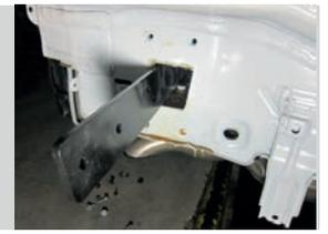
**ШАГ 2.** Закрепите каждую закладную пластину с помощью болта М10х40х1,25 и шайб М10 в дальнем отверстии закладной пластины. Установите кронштейн центральный, совместив его отверстия с отверстиями в закладных пластинах и соедините их с помощью болтов М10х40х1,25, через шайбы гроверные М10 и шайбы М10, гайками М10.
