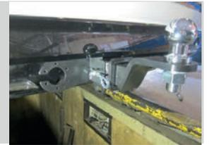
Тип соединения: шаровый; Диаметр сцепного шара: 50 мм.; Масса комплекта ТСУ 20021501: 19,3 кг.
