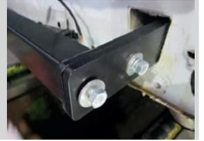
**ШАГ 4.** Затяните все резьбовые соединения. Установите кронштейн нижний совместив отверстия в нём с отверстиями в центральном кронштейне. Закрепите нижний кронштейн с помощью болтов М12х120х1,25 и гаек М12х1,25.
