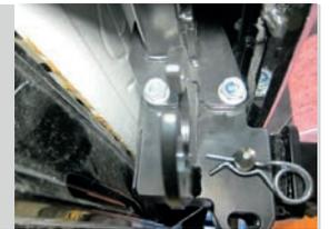
**ШАГ 5.** Установите съемный шар в сборе и зафиксируйте его с помощью пальца гнутого гальванизированного и шплинта пружинного. Затяните шар с помощью ключа на 38 мм. Вкрутите стопорный винт М10х20 снизу. Установка завершена.
