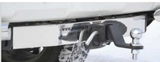
Тип соединения: шаровый; Диаметр сцепного шара: 50 мм.; Масса комплекта ТСУ 09021501: 18,3 кг.
